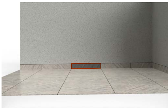
FIGUR 15 B. Sockelplattans övre kant följer golv/väggvinkeln.
