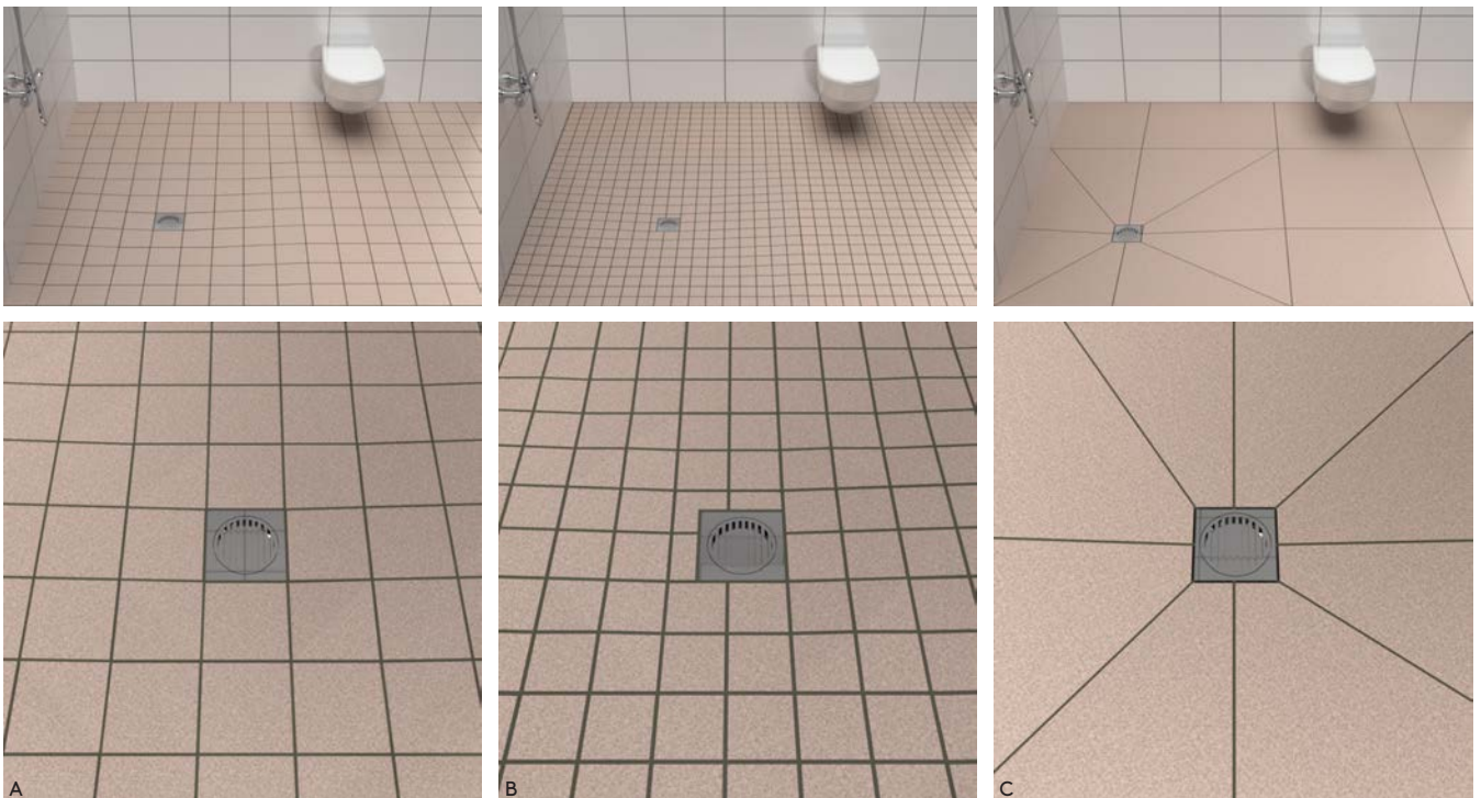
FIGUR 20 A–C. Ovan visas tre sätt att lägga plattor vid fall i duschplats med vanlig brunn.
