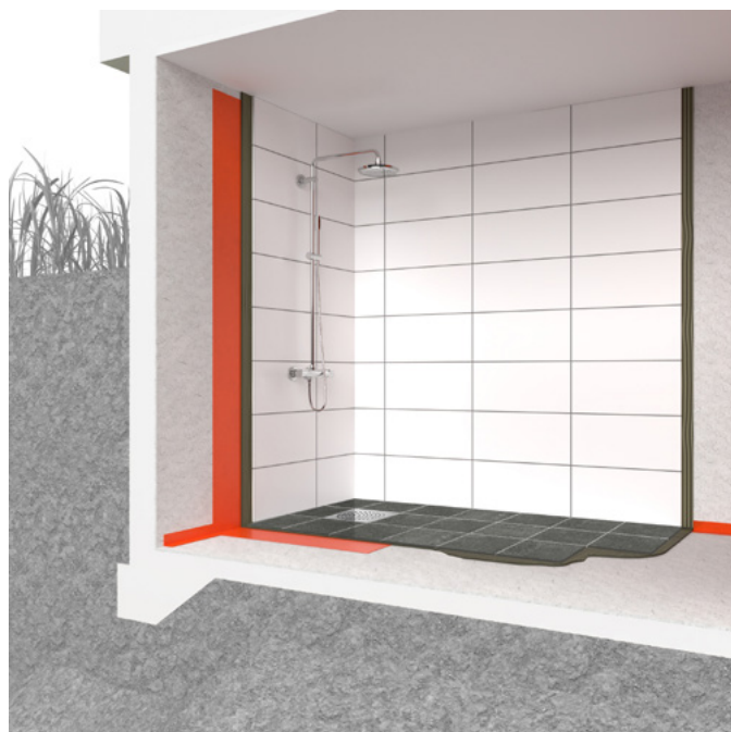
FIGUR 2. Källare med tillskjutande markfukt
