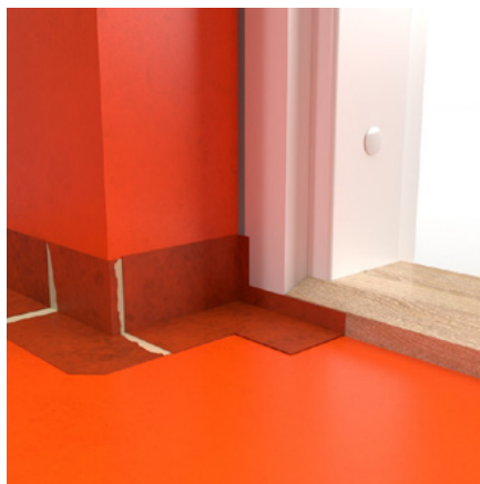
FIGUR 15. Dörr med djup innervägg
