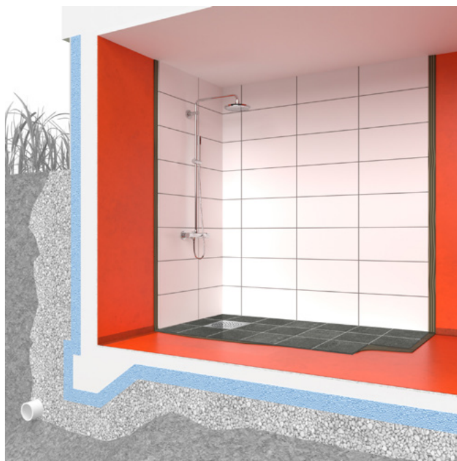
FIGUR 3. Källare utan tillskjutande markfukt
